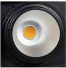
Diese Washlight-Scheinwerfer haben nur eine mittig angebrachte Lichtquelle (COB-LED, ein- oder mehrfarbig) und eine Linse oder einen Reflektor, dadurch ist der Lichtkegel homogener und noch perfekter rund. COB-Scheinwerfer sind aufgrund des größeren Reflektor meist nicht so flach wie Mehr-Linsen-Spots! Der Scheinwerfer hat einen festen Abstrahlwinkel.
